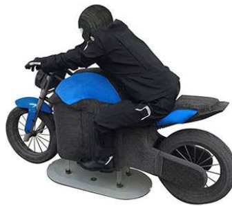
Figura 2: Objetivo o target de motocicleta (PWT)
