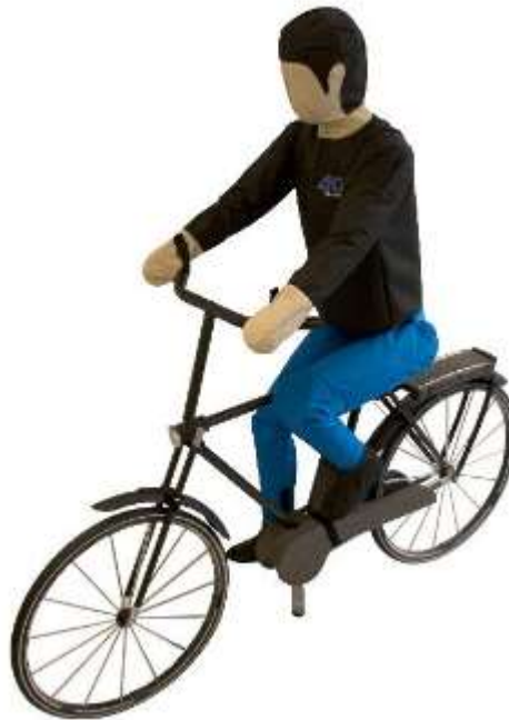
Figura 4: Objetivo o target de ciclista, o usuario vulnerable (VRU2)
